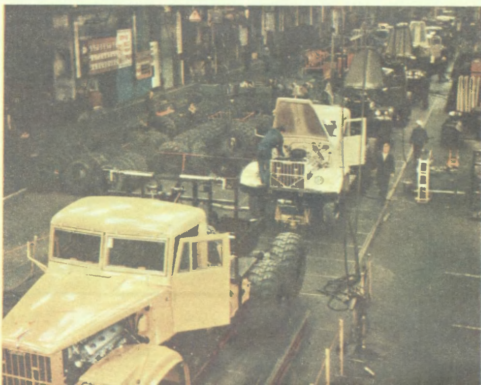
Главный конвейер кременчугского автомобильного завода. Здесь на одной линии идет сборка всех моделей, в том числе машин повышенной проходимости.
